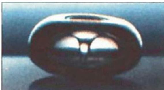
Рисунок 1 – Кавитационный пузырек в момент взрыва
